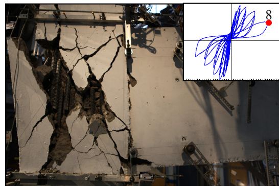
(d) Joint damage at the end of test
