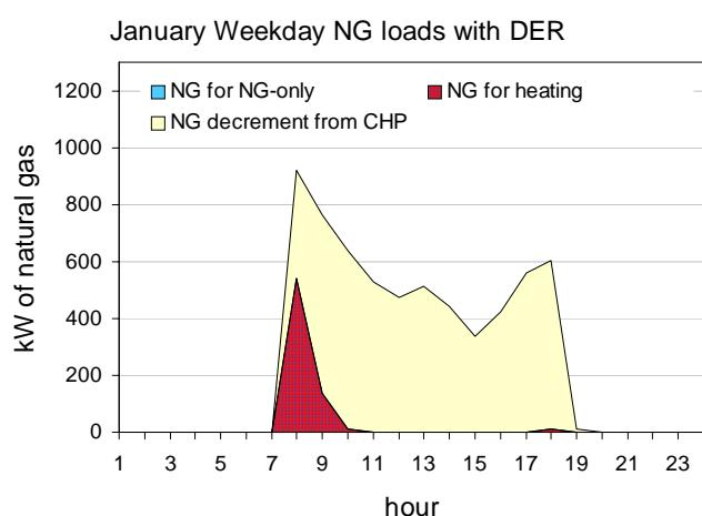
図 4-4-7 CHP導入による暖房負荷削減効果
