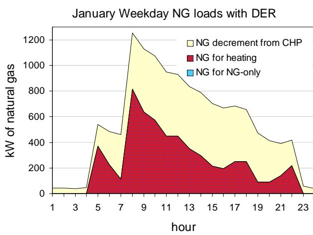
図 4-2-6 CHP導入による暖房負荷削減効果
