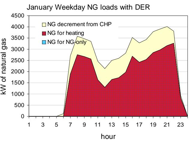
図 4-5-6 CHP導入による暖房負荷削減効果
