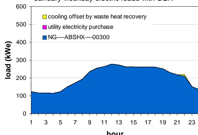
図 4-3-2 CHP 導入による冬季ピーク負荷削減効果
