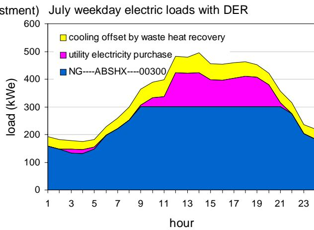
図 4-3-4 CHP導入による夏季ピーク負荷削減効果
