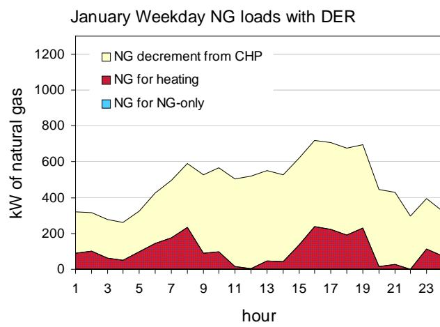
図 4-3-6 CHP導入による暖房負荷削減効果
