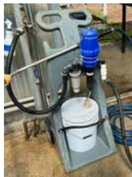
**FIGURA 26.** Inyector de fertilizante en plataforma móvil con accesorios de bloqueo de levas que puede ser fácilmente conectado/desconectado y trasladado del invernadero a la parcela y viceversa.
