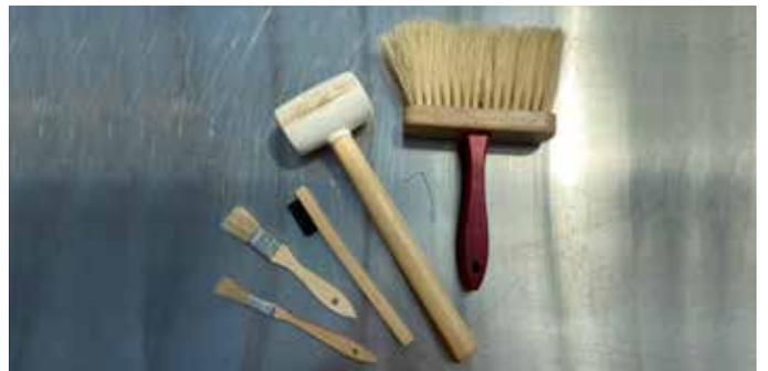
FIGURA 18. Cepillos y mazo para limpiar la sembradora al vacío, eliminar el depósito de doble semilla y apartar las semillas para llenar los huecos en el plato de semillas Fotos: Christof Bernau
