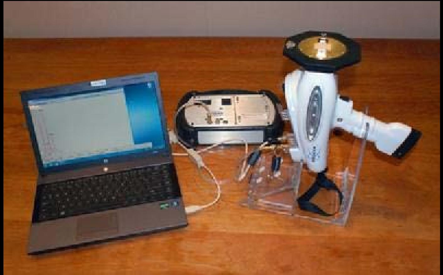
Bruker Tracer III ED-XRF en soporte
