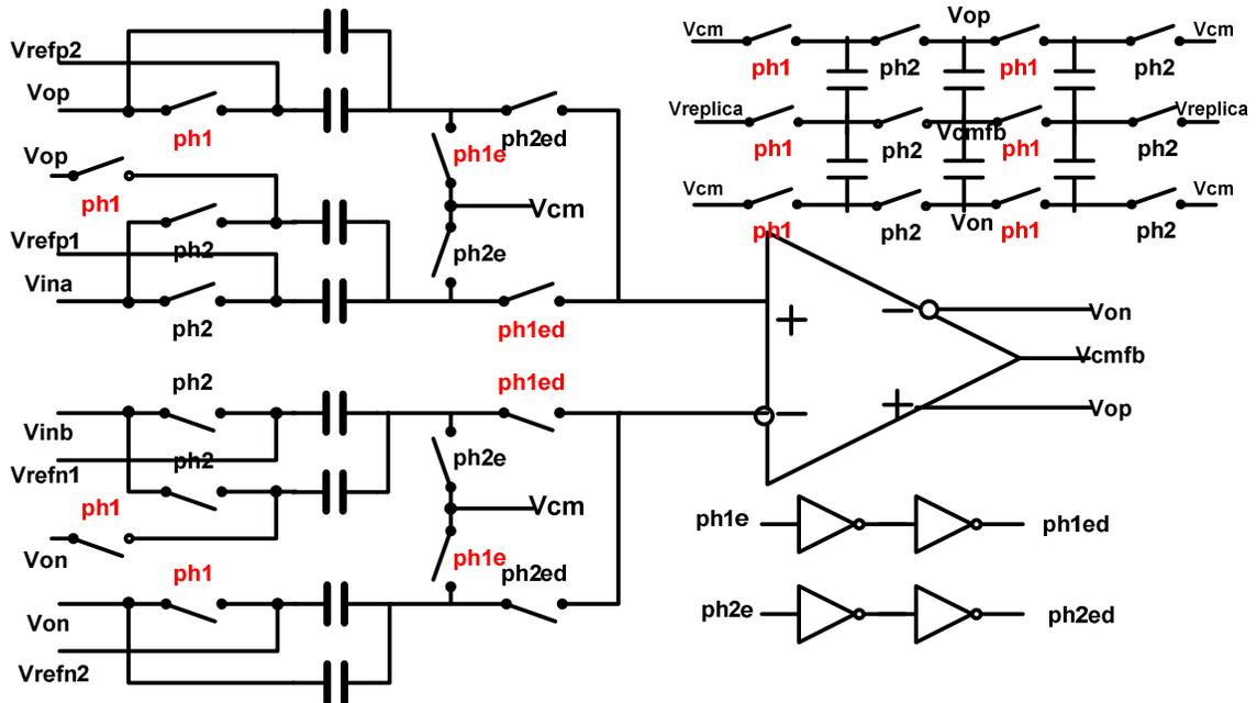
Figure 5.6 1<sup>st</sup> 2<sup>nd</sup> 3<sup>rd</sup> MDAC.
