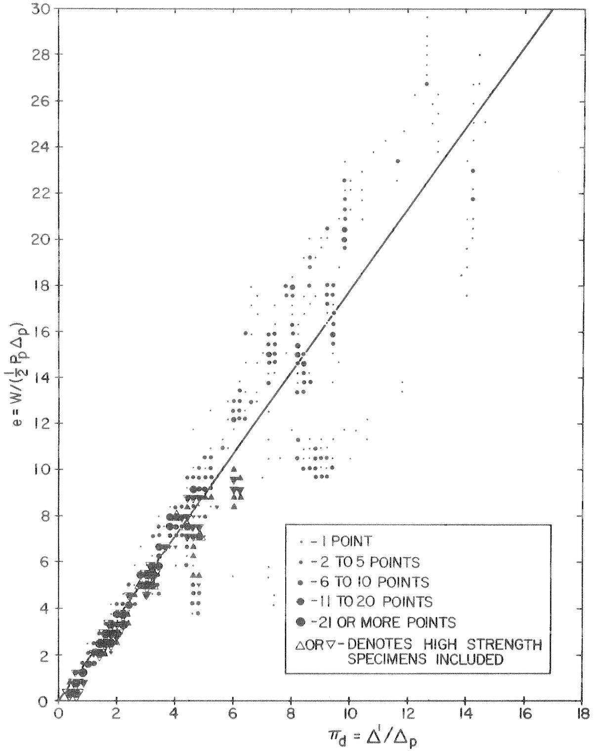
FIGURE 27- ENERGY RATIO VERSUS PLASTICITY RATIO
