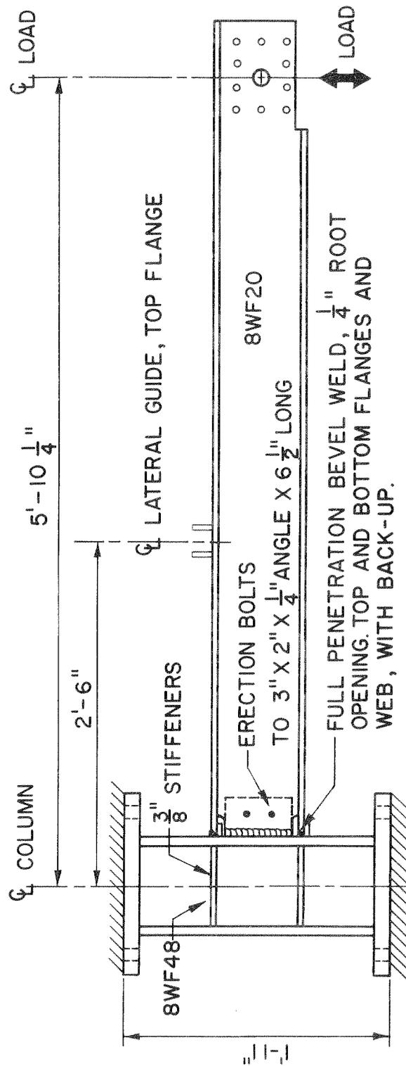
FIGURE 1 - SPECIMEN TYPE FI
