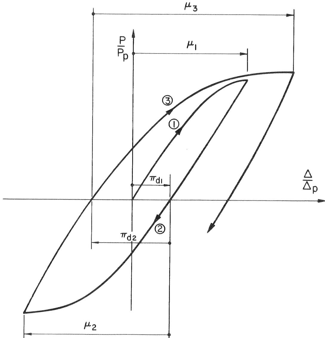
FIGURE 26 - DEFINITION OF DUCTILITY FACTOR  $\mu$
