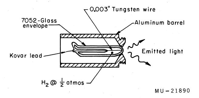
Fig. 8. Corona lamp (two times actual size).
