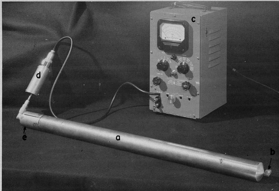
(a) stem (d) diode probe adaptor (b) tip with offset spacer (e) stem coupling box (c) H.P. 410A VTVM
