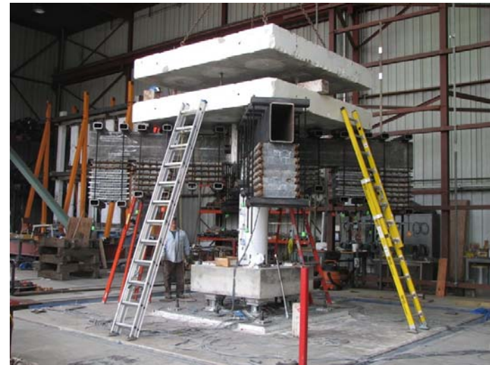
(d) Installing the second concrete block
