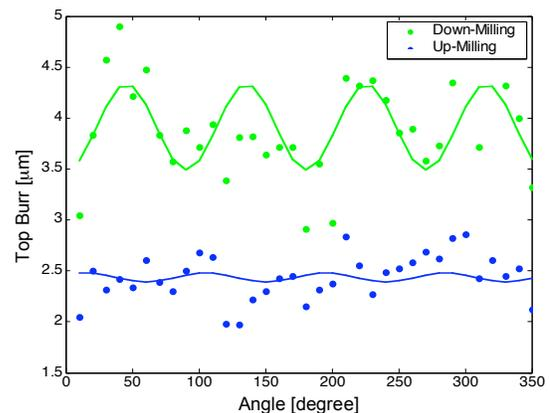
FIGURE 9. BURR HEIGHT VARIATION FOR (100) WORKPIECE.
