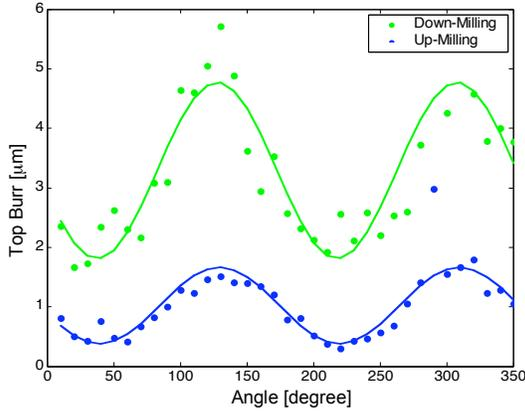
FIGURE 10. BURR HEIGHT VARIATION FOR (110) WORKPIECE.
