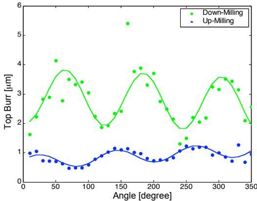
FIGURE 11. BURR HEIGHT VARIATION FOR (110) WORKPIECE.
