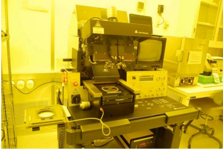
Fig. 3.4 Karl Suss MA6 Mask Aligner (UC-Irvine INRF)
