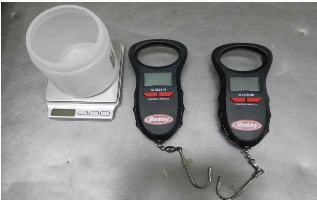
**Figura 3.** Diferentes tipos de básculas utilizadas durante el monitoreo biológico. Las básculas negras tienen capacidad de 25kg con una precisión de 0.01kg; la báscula gris tienen una capacidad de 2 kg y una precisión de 0.01gr.
