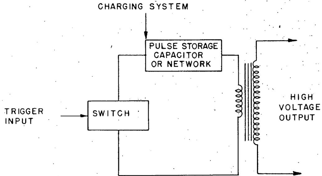
BASIC CIRCUIT FOR ENERGIZING THE PRIMARY CIRCUITS OF THE PULSE TRANSFORMERS.
