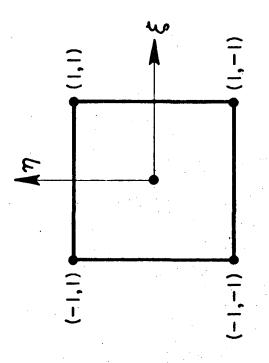
FIG. I BILINEAR ISOPARAMETRIC QUADRILATERAL
