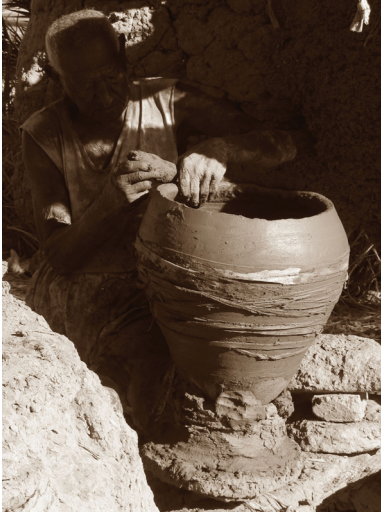
Fig. 9. Potier façonnant un zîr par montage de colombins repris au tour, Abri 2008, photo R. David.
