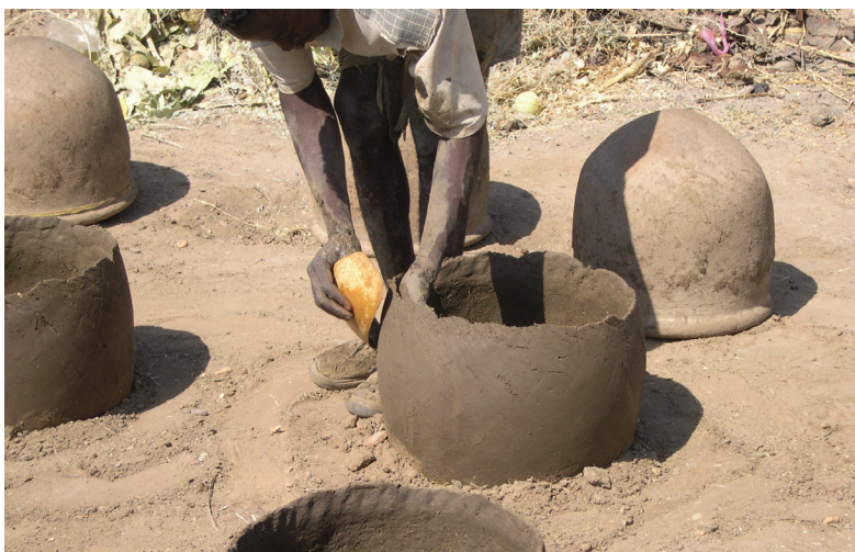
Fig. 2. Potier façonnant un zîr par moulage sur forme convexe puis aux colombins, Shendi 2007, photo R. David.
