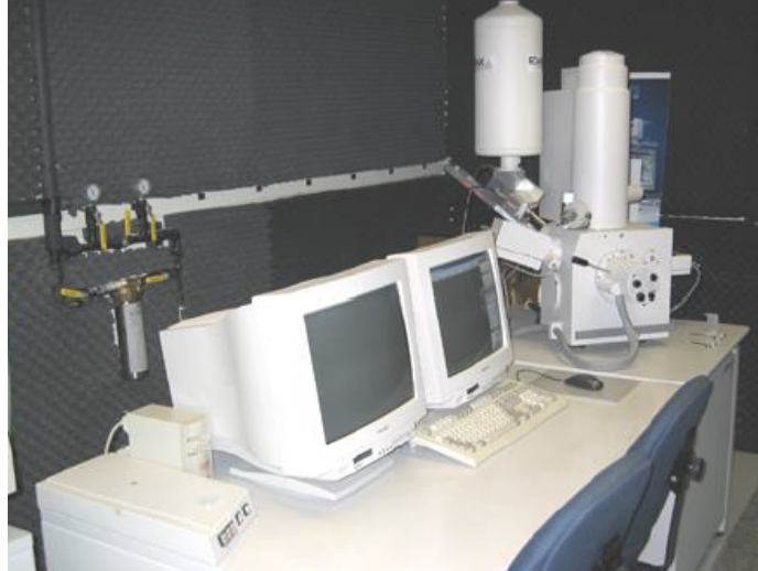
Fig. 2.7 Philips XL-30 FEG SEM
