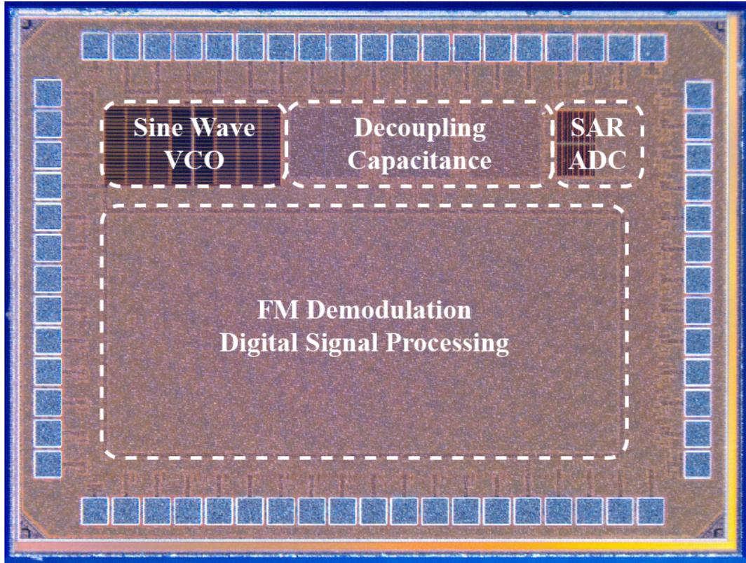
**Figure 2.8:** FM-ADC die photograph. Total die size  $1.5\text{mm}^2$ .
