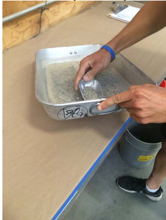
(d) Use a flat-bottom scoop to take materials.
