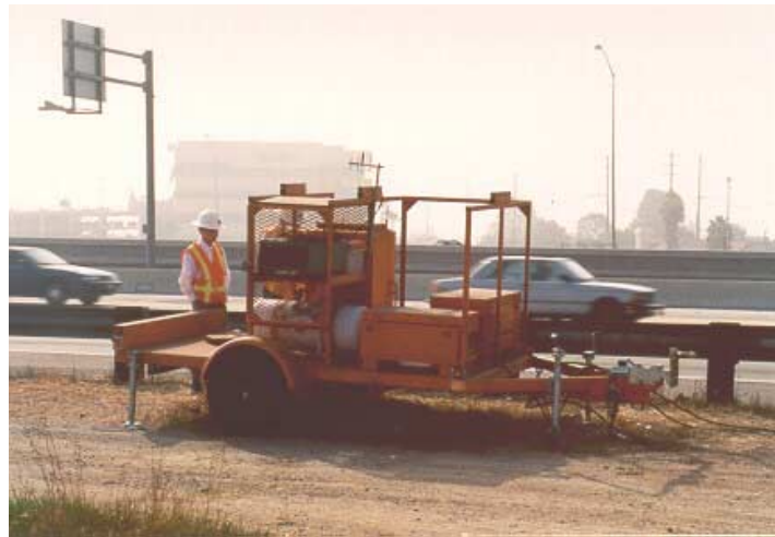
(b) Ramp meter trailer
