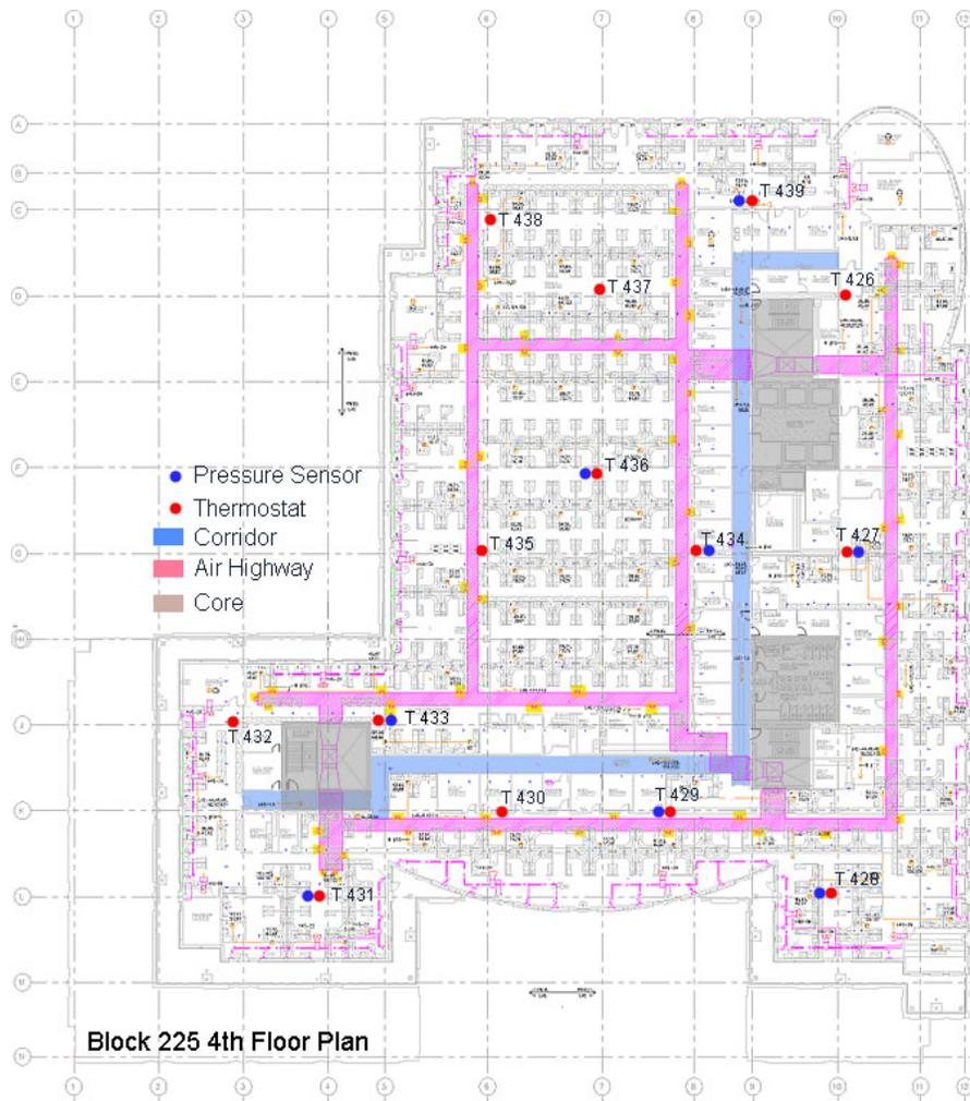
Figure 3-4. B225 4<sup>th</sup> floor plan
