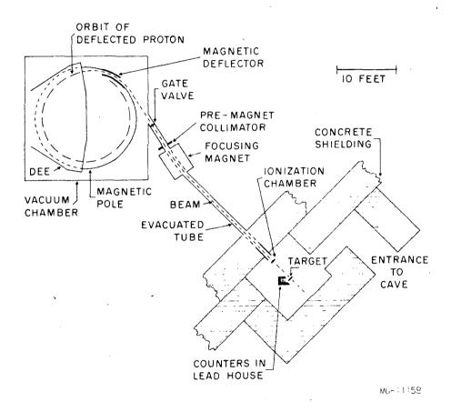
Fig. 3. Cyclotron Arrangement.
